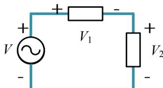
$$V - V_1 - V_2 = 0$$
